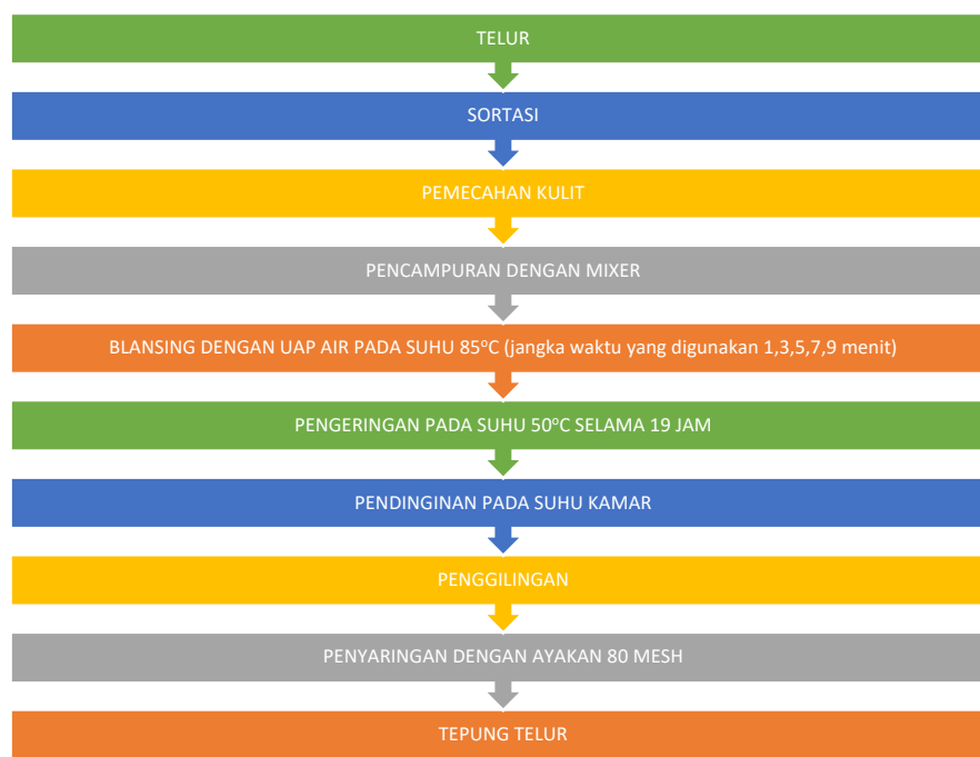
Gambar 2. Diagram Alir Pembuatan Tepung Telur dalam percobaan
